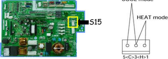
Utilizzare il connettore S15 per impostare l'unità al solo raffreddamento o al solo riscaldamento.
