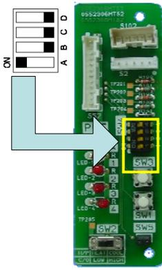
Selezionare un solo ambiente mediante il selettore SW4
