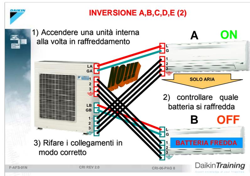
E' necessario eseguire la procedura in freddo, poiché in caldo, potrebbe essere difficile, se non impossibile, capire quale unità interna viene riempita dal gas caldo. In inverno, con temperature esterne basse sarà necessario forzare l'avviamento della macchina mediante il comando a raggi infrarossi, eseguendo la procedura di "test" (vedi manuale di istruzioni della macchina):
