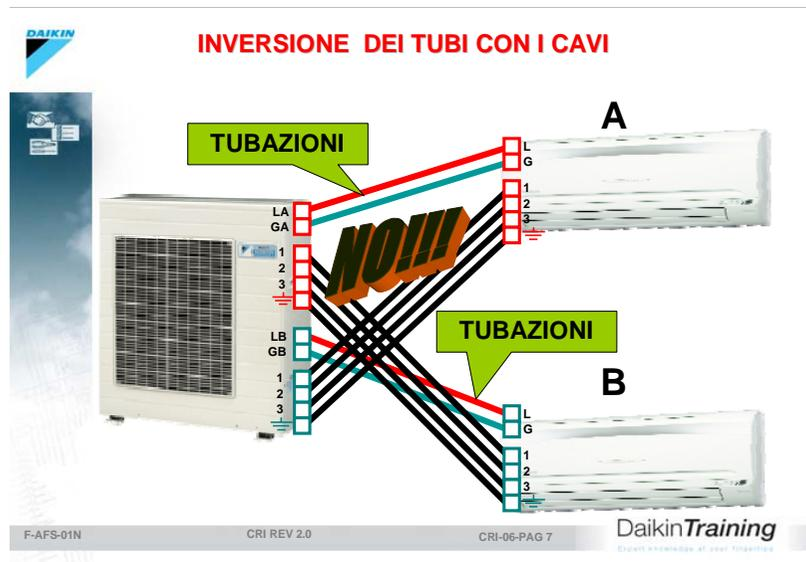
Negli impianti multi system, le unità vengono identificate da lettere (A, B, C, D). Ogni unità interna è connessa all'esterna mediante le tubazioni ed il cablaggio, esattamente come nei sistemi monosplit. In questo caso, oltre alla inversione "1,2,3", esiste al cosiddetta inversione "A, B, C, D".
